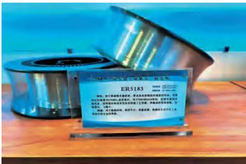
图 53 2022 年, 五二研究所研制的 ER5183 铝合金焊丝力学性能和表面光亮化程度均达到先进水平, 实现进口焊丝国产化替代。图为 ER5183 铝合金焊丝 (五二研究所 供图)
