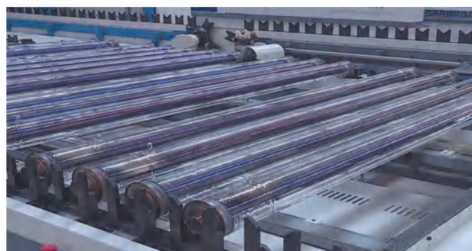
内蒙古旭宸能源有限公司生产的太阳能镜场真空集热管
