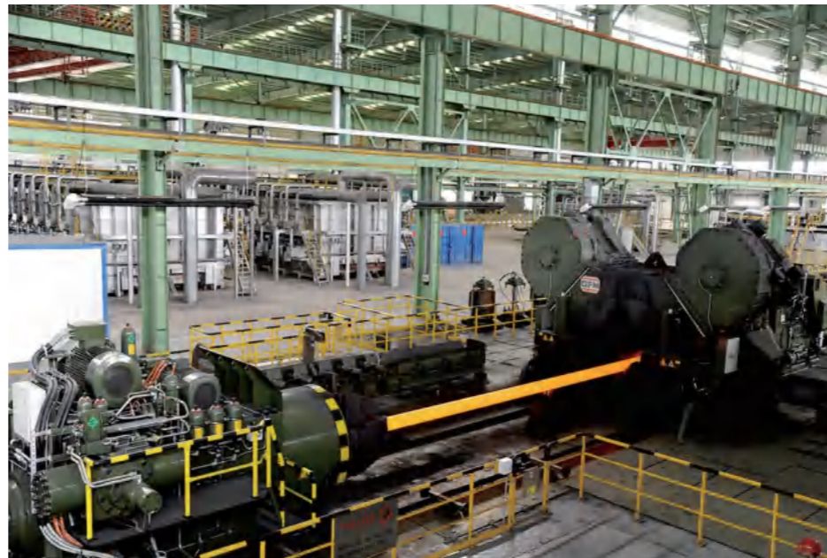
内蒙古北方重工业集团有限公司 1600 吨精锻机生产线
