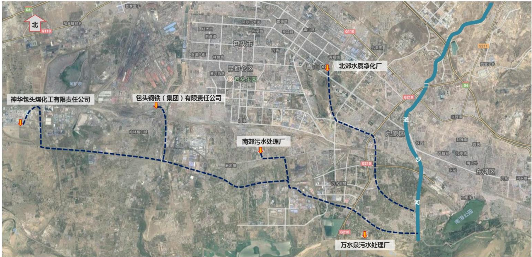
图 7-5 污水处理厂位置分布及尾水入二道沙河管线示意图
